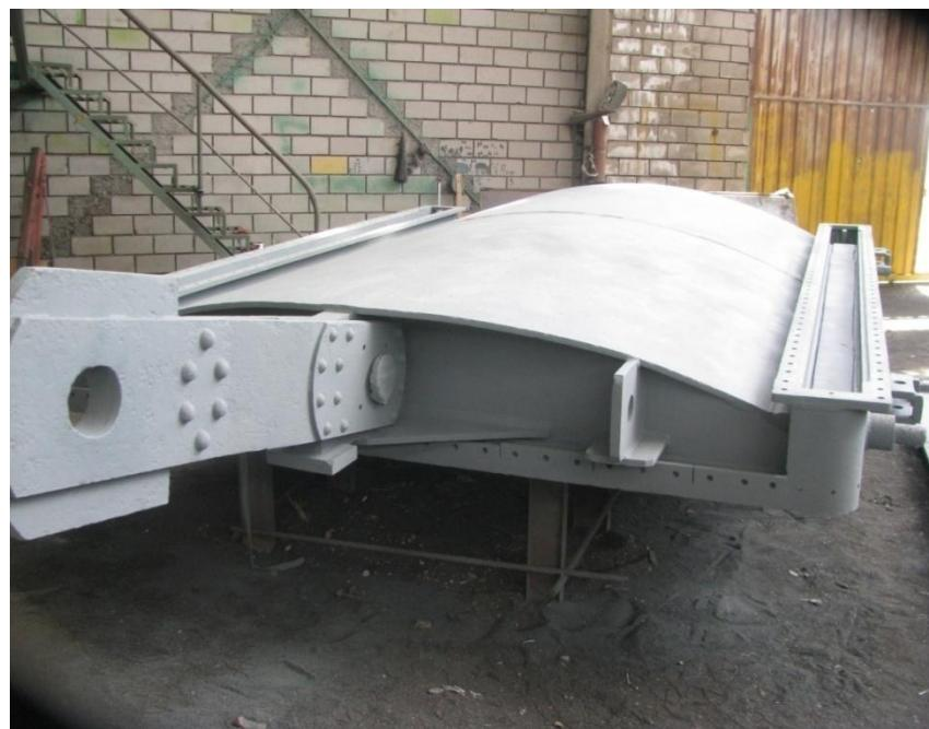
۷-۲۵- رنگ آمیزی کامل دریچه و بازوها با دو لایه رنگ پرایمر زینک اپوکسی و لایه نهایی کولتار با ضخامت‌های تعریف شده و استاندارد
