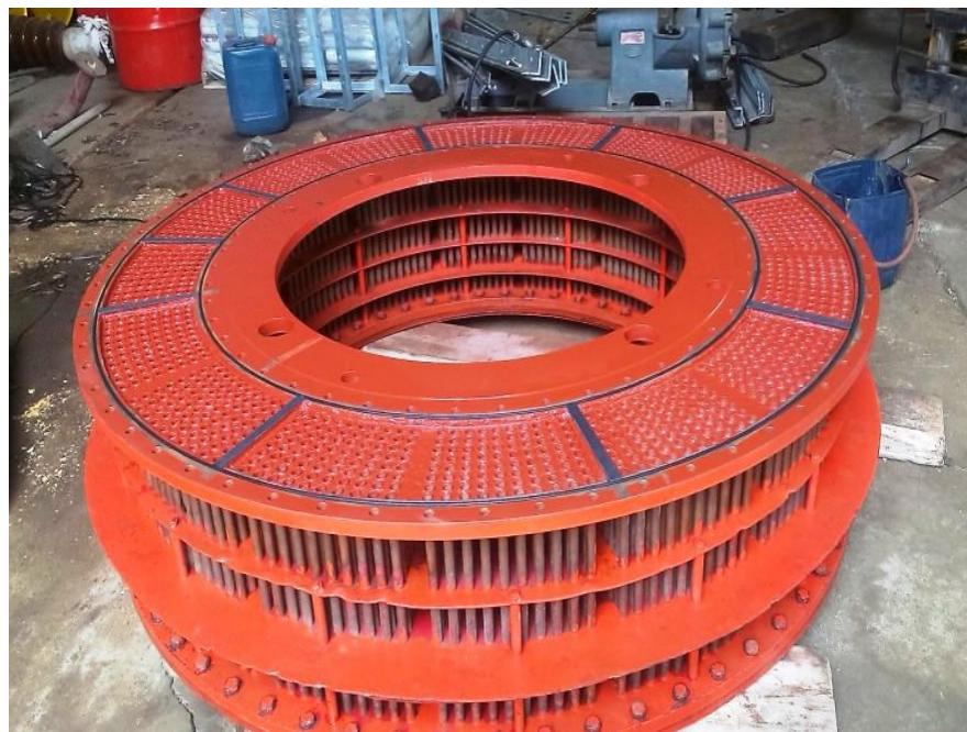
۱۲-۱۲-تست مبدل حرارتی با پمپ دستی آب فتحت فشار ۱۰ بار به مدت ۲۴ ساعت
