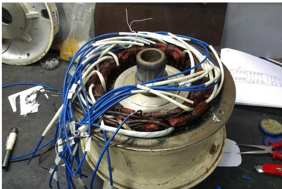
۱۰-۴- اتصال سیم‌های نو به وسیله لحیم و فرم دادن سیم‌ها و نصب سرسیم مناسب
