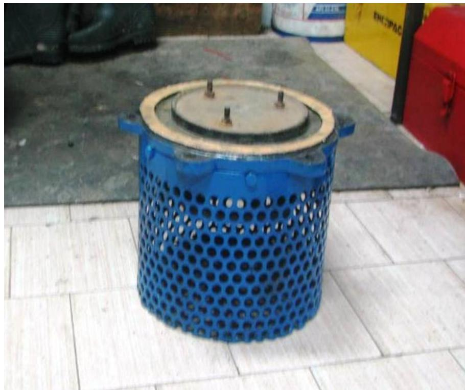
۲۲. دمونتاژ و تعویض الکتروپمپ کف کش چاله زهکشی به علت سوختگی پمپ
