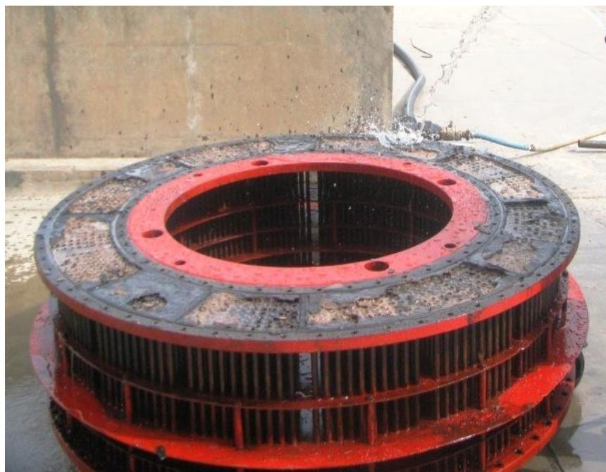
۱۰-۱۲- سرویس لوله‌های مسی مبدل حرارتی با فرچه مخصوص و شستشوی آن با پیستوله و تینر به تعداد ۱۲۷۰ لوله
